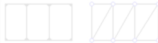
Рис. 2.4. Фермова конструкція (зліва) і розрахункова схема ферми (праворуч).
